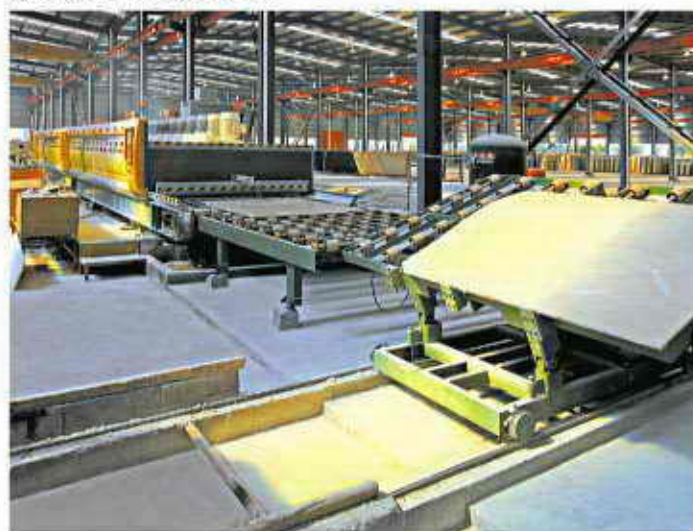
意大利连续抛磨机 Italian automatic chamfering and edge polishing machine
